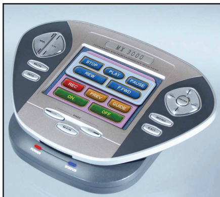
МХ-3000 на зарядном устройстве
